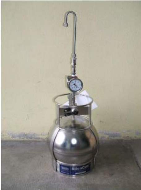
Figure 28 – Illustration d'un conteneur sous dépression (canister 6 L (source : projet Citychlor))
