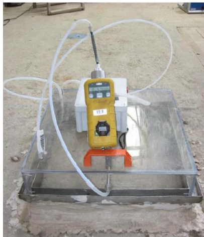
Chambre INERIS à flux® sur dalle béton avec suivi des concentrations en gaz au PID (source : INERIS)
