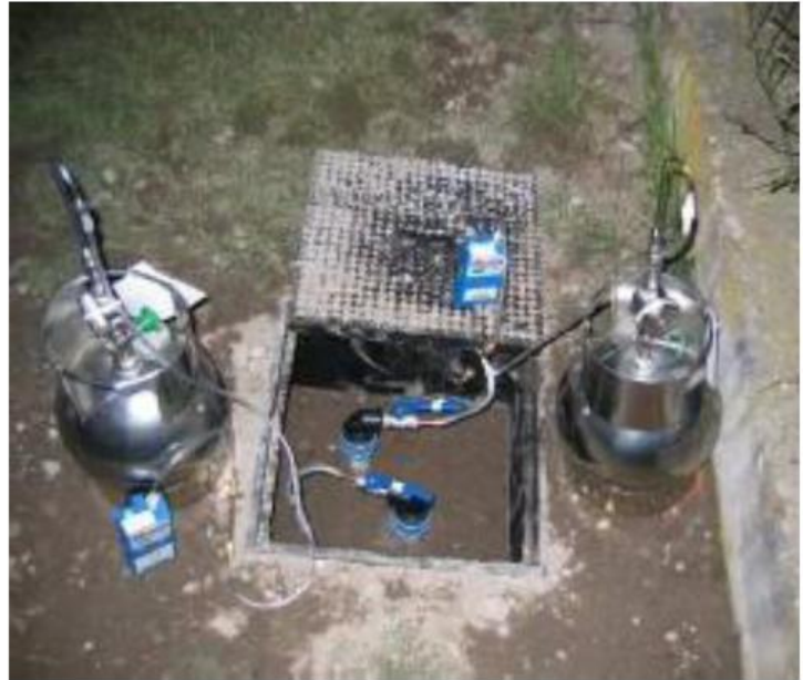
Figure 28 – Illustration d'un conteneur sous dépression (canister 6 L (source : projet Citychlor))
