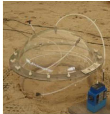
Chambre à flux Odoflux (Odotech) sur sols à nu avec pompage des gaz (source : projet Fluxobat)
